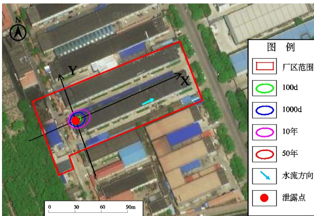
图 8-2 非正常状况下不同时间点 COD cr 污染羽 (5mg/L) 影响范围示意图
