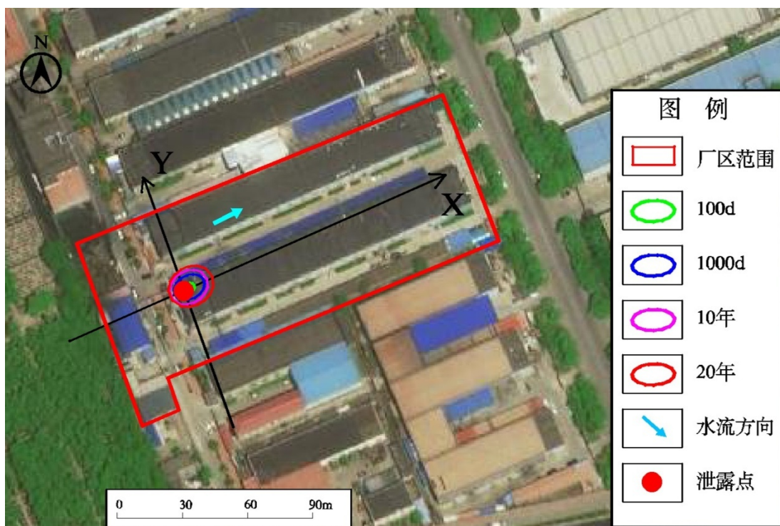
图 8.3-1 非正常状况下不同时间点 COD cr 污染羽 (20mg/L) 污染范围示意图
